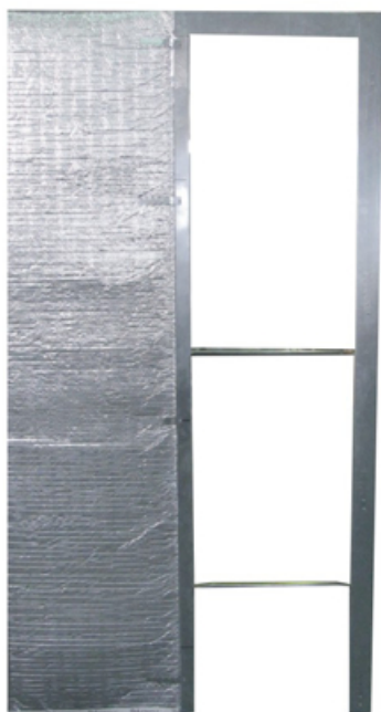
Vista esterna con materiale termoisolante
